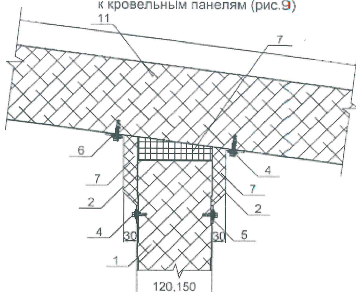
Примыкание противопожарной стены к кровельным панелям (рис.9)
