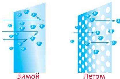
Установка гидро- и ветроизоляционных мембран обязательна при устройстве теплоизоляции:
