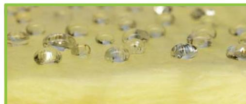
Особенность **ISOVER СкатнаяКровля** — низкое значение водопоглощения при частичном погружении за 24 ч —  $0,08 \text{ кг}/\text{м}^2$ . Это обеспечивает дополнительную защиту от влаги.
